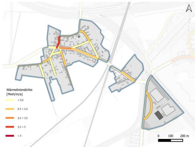
Wärmeliniedichte (Indikator für Wärmenetz)
